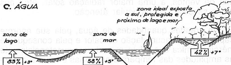
Fig. 25 — Quantidade de calor Q (em percentagem) que um edifício perde, em diversos posicionamentos, sob a influência exercida pelos factores A, B e C. As variações das temperaturas médias do ar, em graus centígrados nos períodos frios, revelam as diferentes situações microclimáticas de um local (fonte 19).
